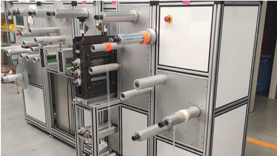
Abb. 5.7 Foto einer realen Rotationsstanze in der Produktionshalle der Shufani
